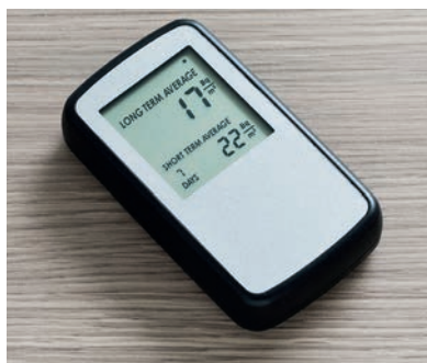
Figura 4- Dispositiu electrònic de mesurament del radó en interiors
