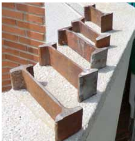
SECCIONS REALS DE PERFILS D'ALA ESTRETA
