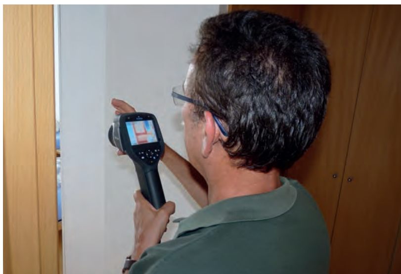
Anàlisi termogràfica a càrrec de l'auditor energètic Eudald Pérez
