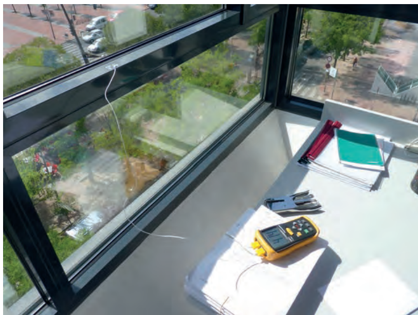
Anàlisi termofluxomètrica en tancament de façana a Sabadell
