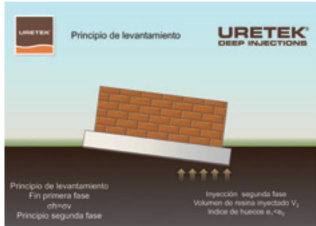
Figura 5. Segunda fase del principio de levantamiento.
