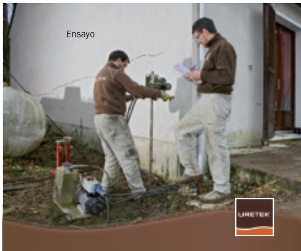
Figura 15. Realización de penetrómetro de comprobación.
