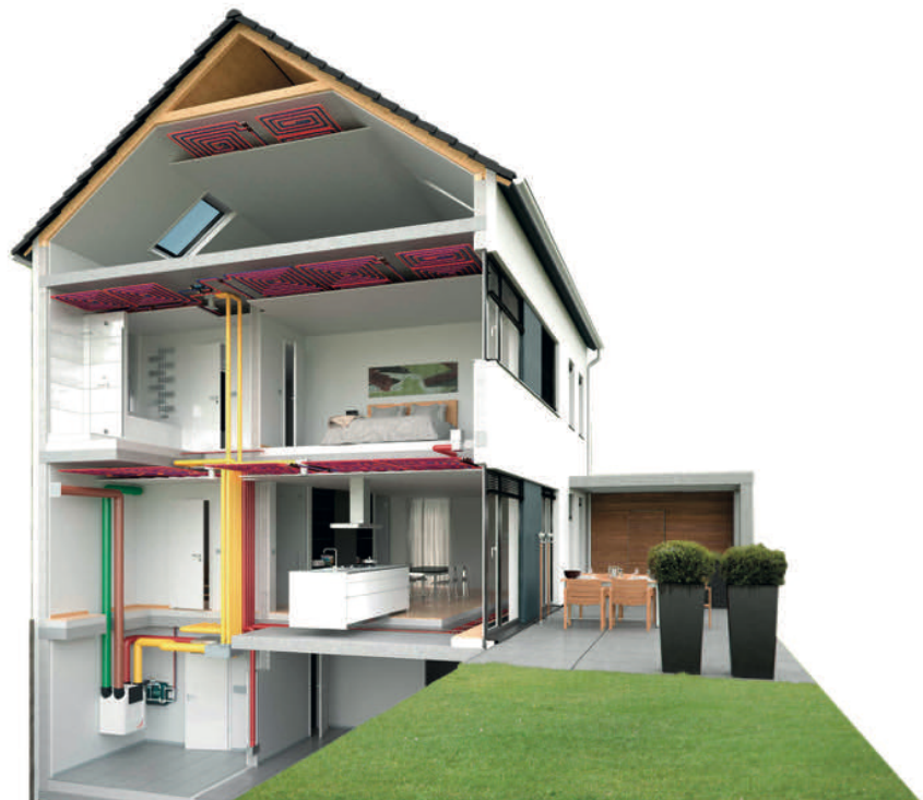
Sistema de ventilació mecànica Zehnder
