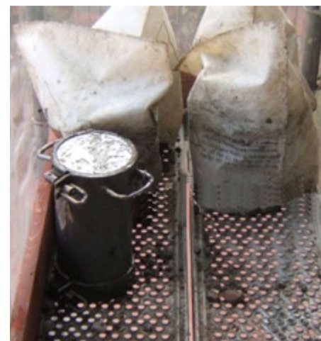
VIBRAT DEL FORMIGÓ D'UNA LLOSA DE FORMIGÓ I PROVETA PREPARADA PER ENVIAR A LABORATORI PER TAL DETERMINAR LA QUALITAT DEL MATERIAL FABRICAT A OBRA. OBRA EXECUTADA PER TRAC L'ANY 2009
